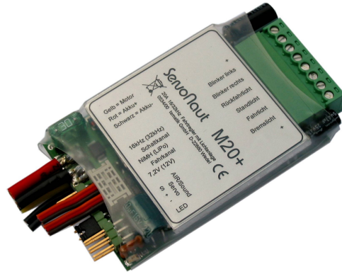
Abbildung 5: Aktueller 20A Fahrtregler für Funktionsmodelle mit Lichtanlage auf der Basis eines 68HC08
