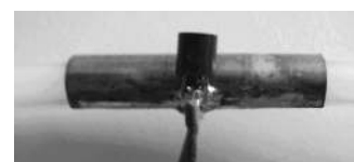
Abbildung 8: Kupferfolie auf Rohr
