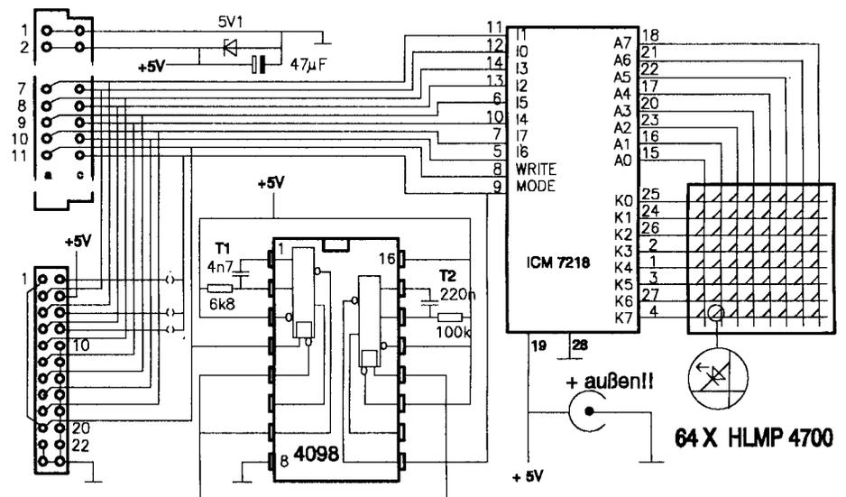
Rückleitung. Mit einer 2-Lagen-Platine ist das nicht ohne große Abstände zwischen den LEDs zu machen. Hand-Verdrahtung ist daher angesagt. Der hohe Bauteil-Aufwand erfordert zusätzlich Platinen-Fläche.
